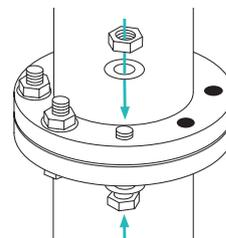
2. Montieren Sie die Schrauben, Unterlegscheiben und Muttern am Flansch.
